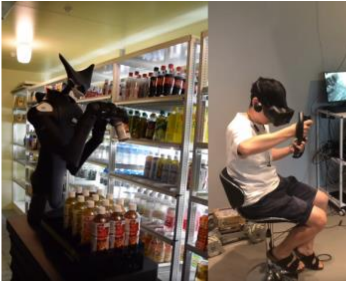
Abbildung 4: Virtuelle Fernsteuerung von Robotern im Supermarkt (Quelle: Telexistence Inc.)
