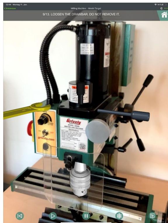
Abbildung 6: Demontage des Bohrfutters
