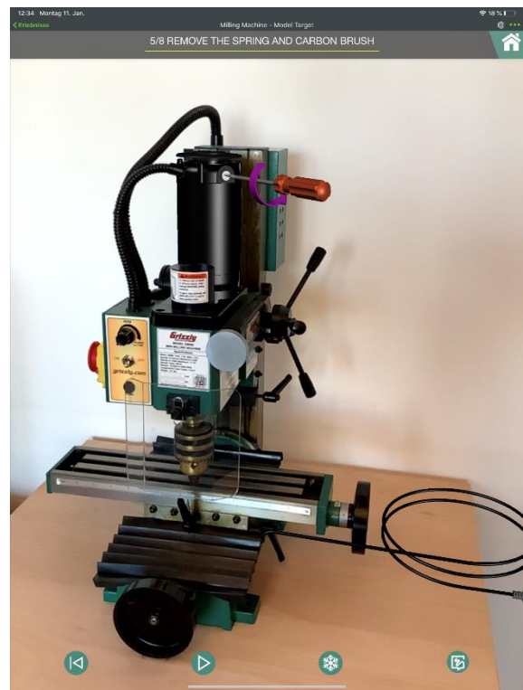
Abbildung 8: Demontage der Kappe des Motorgehäuses
