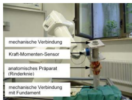
Aufnahme Kraft-Weg-Verlauf (hier noch mittels Tierpräparat) Quelle: TU München
