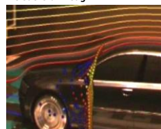
Simulationsergebnis Aerodynamik über Versuchsfahrzeug
