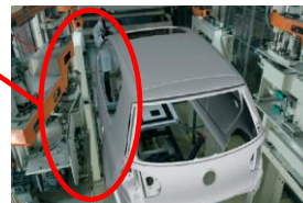
Kollisionsanalyse: Sicht entlang der Störkante
