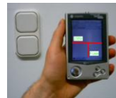
Anzeige von Nicht-Sichtbarem: Infrastruktur unter Putz
