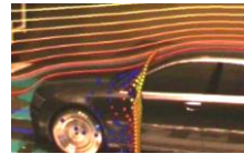
Überlagerung digitales Strömungsmodell über Versuch: wie gut ist das Modell? (HLRS)
