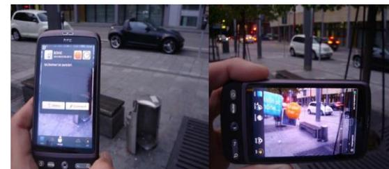
**Geo-Tagging:** Markieren und Kommentieren von realen Objekten und Standorten, z.B. Beschädigungen, potentielle Gefahrenstellen etc.. Schaden an öffentlichen Objekten „melden“ mit SEKAI CAMERA [Quelle: Schrenk, M. et al.: Mobile Augmented City—New Methods for Urban Analysis and Urban Design Processes by using Mobile Augmented Reality Services. Proceedings REAL CORP 2011 Tagungsband 18-20 May 2011, Essen.]
